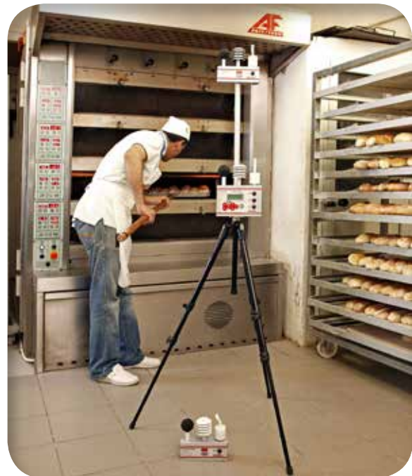
WBGT a tre livelli sulla stessa verticale
