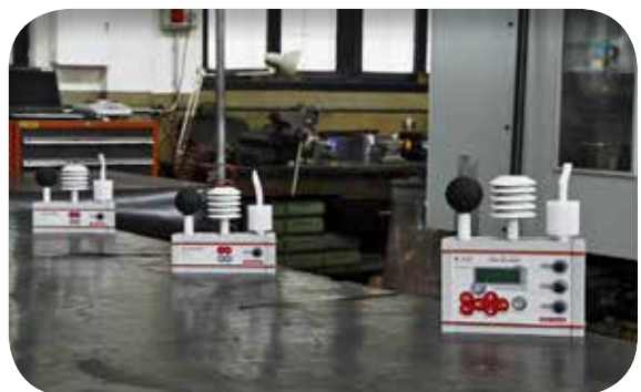
WBGT in tre posizioni dello stesso ambiente
